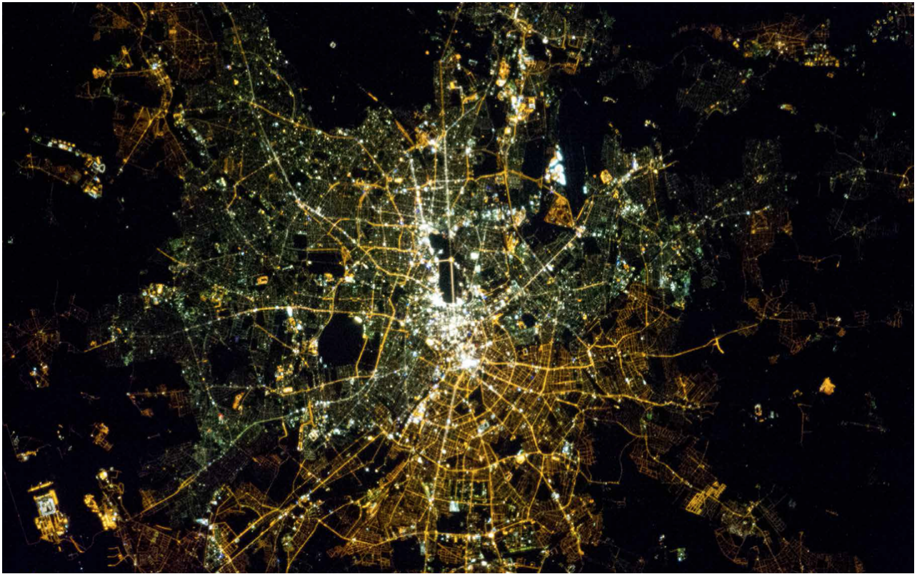
Figure 5- Si le mur de Berlin est tombé depuis longtemps, l'égalité n'est pas encore entièrement retrouvée dans la capitale allemande actuelle, et cela se voit même en ce qui concerne les éclairages publics ! On discerne nettement, sur cette vue de l'espace, les éclairages récents à LED, plus blanc-bleutés, et les anciens, jaunâtres, des lampes à sodium. Crédit : ESA/NASA
